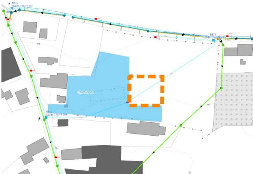
ABBILDUNG 21 : TRINK- UND ABWASSERSTRUKTUREN MIT KENNZEICHNUNG DES NEUBAUGEBIETS „WISSGAART“ (BLAUE FLÄCHE) UND DESSEN ERWEITERUNG ÄNDERUNGSFLÄCHE 04 (ORANGE MARKIERUNG)
