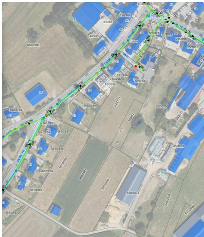
En ce qui concerne les canalisations existantes, le projet sera raccordé au réseau d'assainissement mixte existant géré par le Syndicat des eaux résiduaires du Nord (SIDEN) et au réseau d'évacuation des eaux de surfaces projeté. Le raccord principal se situe dans la rue « Wissgaart ». Les raccords individuels seront planifiés dans le cadre du PAP NQ.
